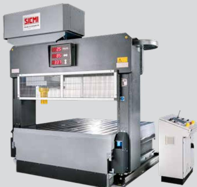
Controllo d'assi, movimenti controllati da attuatori elettrici, possibilità di programmare la raddrizzatura.
