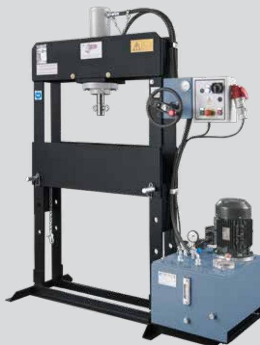
L'idroguida permette di lavorare con una mano sola e di gestire con la massima precisione anche il centesimo. Innovativa, comoda e funzionale.
